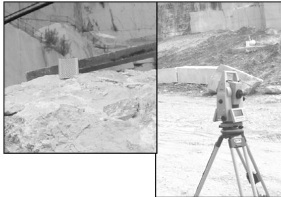
Figura 4.1: collimazione del target di tipo cilindrico con stazione totale per la successiva georeferenziazione.
