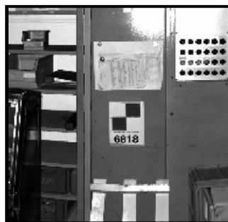
Figura 3.12 Geo-referenziazione attraverso punti a coordinate note
