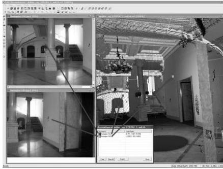
Figura 2.15 l'utilizzo dello strumento annotation permette di associare un range scan alle immagine 2D da mappare ed organizzare in modo efficiente le successive operazioni di scansione.
