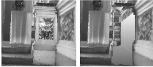
Figura 4.4: Modelli rappresentanti una zona d'ombra integrata ed una zona integrata con mesh ad alta risoluzione.
