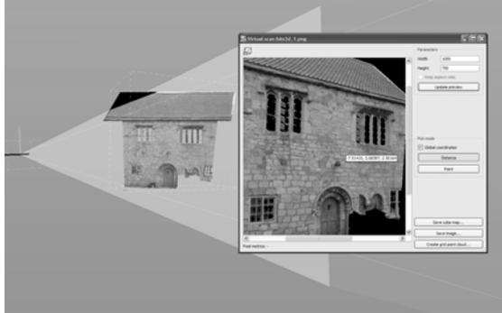
Figura 5.2 – La scansione virtuale effettuata alla stessa posizione di una camera fotografica con cui è stata effettuata una foto dell'edificio, consente di generare una immagine 2D analoga all'originale con le coordinate di ogni pixel note in 3D.
