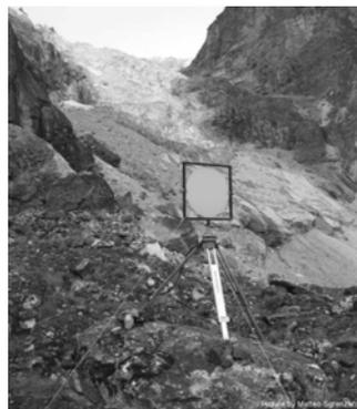
Figura 4.3: sistema integrato, dove target ed antenna GPS sono solidali e quindi le loro reciproche posizioni sono note.
