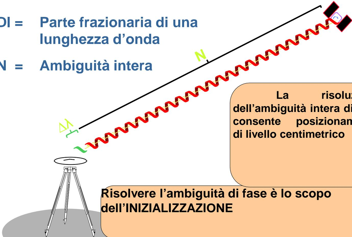
La risoluzione dell'ambiguità intera di fase consente posizionamento di livello centimetrico
