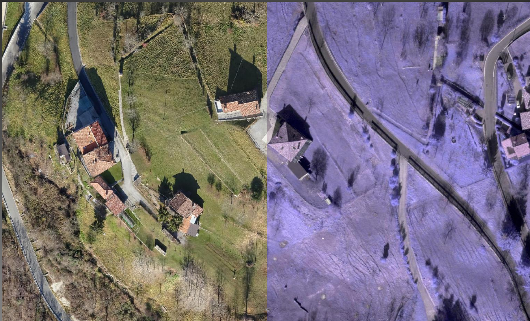
Rilievo in falsi colori mediante sensori NIR
