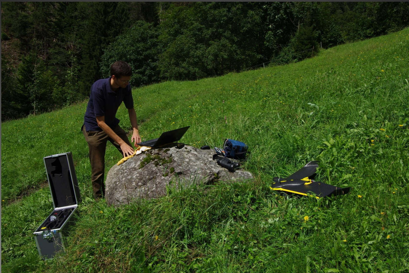
Verifica del piano di volo e invio allo strumento pronto al volo
