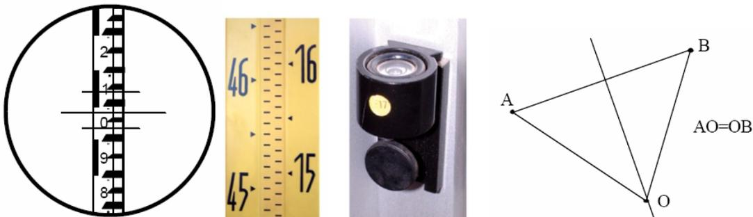
Fig.14: dettaglio di una stadia graduata e schema delle osservazioni da un punto equidistante
