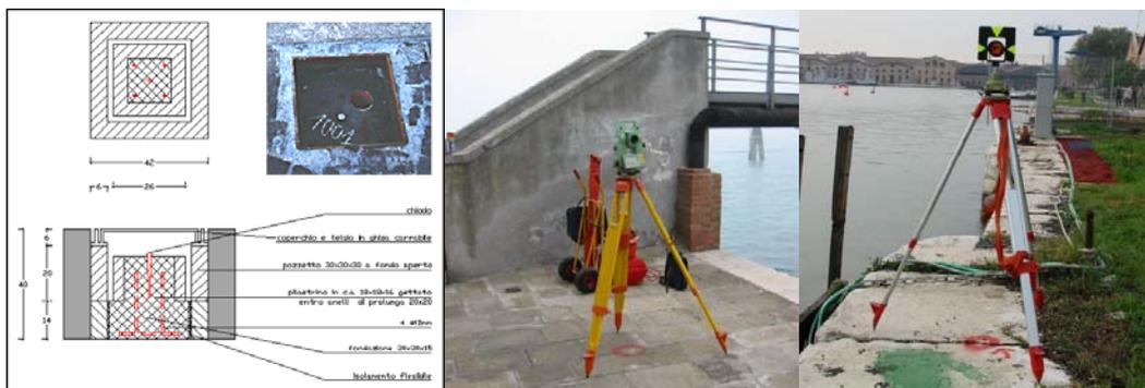
esempi di caposaldo su pozzetto in cemento; punto di stazione e punto collimato con prisma riflettente
